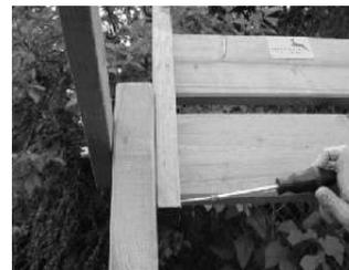
5. Die Neigung der Rückenlehne individuell einstellen und mit Spaxschrauben fixieren. Ringschraube seitlich in die Fußablage schrauben, als Erleichterung zum hoch- oder herunterklappen.
